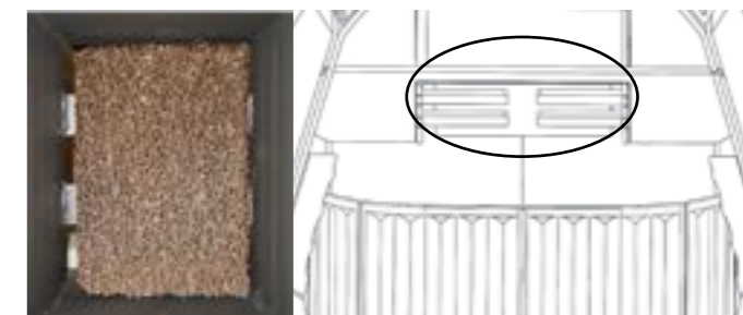
De locatie van de katalysator, gezien vanaf de rookgasafvoer boven de rookgasdeflectorplaat.
