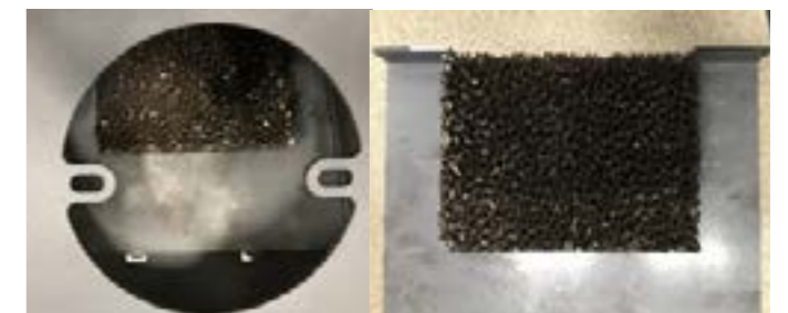
Katalysatormontage gezien vanaf de rookafvoer boven de vermiculiet rookkeerplaat.
